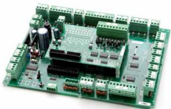
Scheda elettronica seriale per cabina ascensore basata sul sistema di comunicazione seriale CAN Bus (Controller Area Network) | Possibilità di comunicazione seriale con l'unità centrale (quadro ascensore) | Controlla tutti i componenti di cabina.
