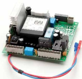
Scheda elettronica per rialimentazione quadro oleodinamico in emergenza con possibilità di riapertura porte a 48Vdc | Carica batterie 12V 7Ah + luce d'emergenza
